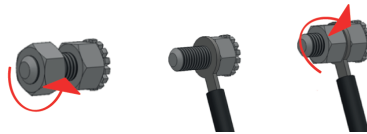
Abb. 4. Anschluss des Geräts an ein elektrisches Potenzialausgleichssystem
