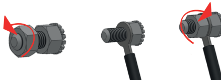
Bild 7. Der Anschluss des Gerätes an die Einrichtung zum Potentialausgleich
