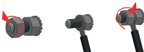
Figure 7. Branchement de l'appareil au dispositif équipotentiel
