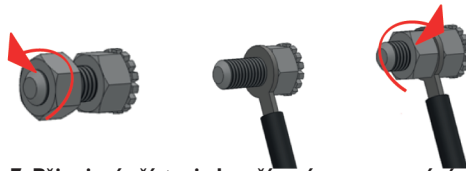
Obrázek č. 7. Připojení přístroje k zařízením pro vyrovnávání potenciálu.
