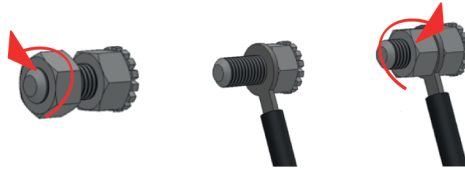
Obrázok 7. Pripojenie zariadenia k vyrovnaniu elektrických potenciálov.
