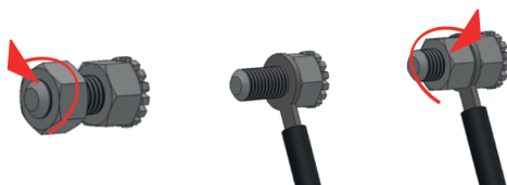
Figura 7. Conexión del equipo a una instalación equipotencial.
