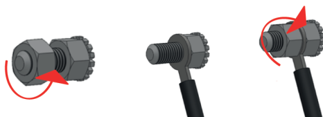
Bild 3. Der Anschluss des Gerätes an die Potentialausgleichsanlage
