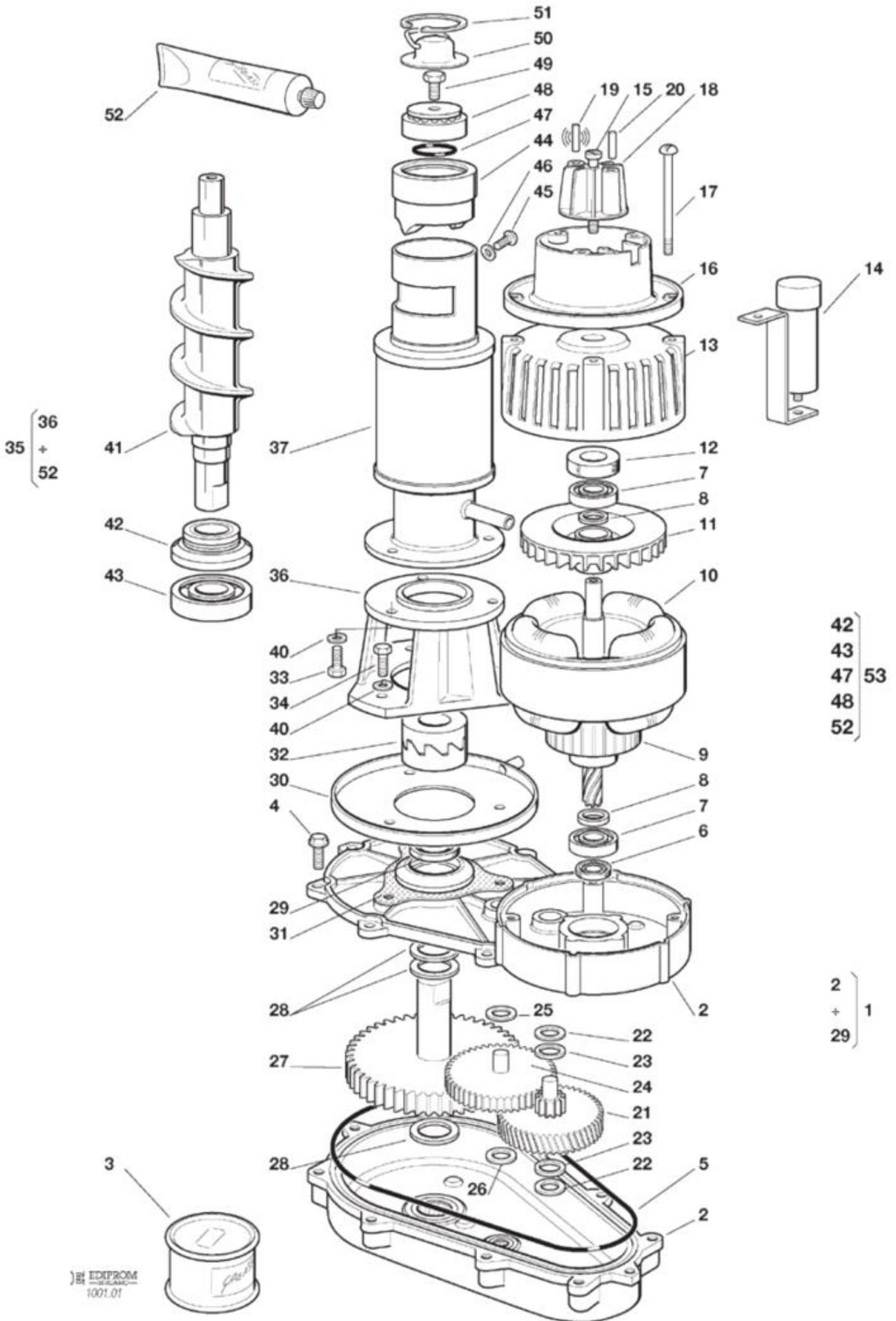
**GEFRIERZYLINDER-GETRIEBEEINHEIT - BIS S.N.
