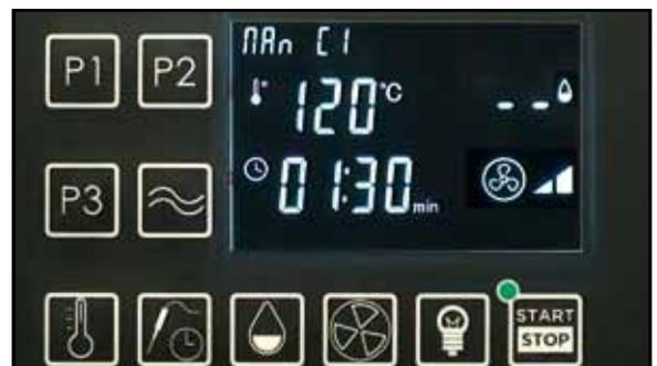
Beim Einschalten des Geräts gelangt man auf eine in der Abbildung dargestellte Bildschirmseite. Standardmäßig ist ein manuelles Programm mit einfachem, zeitbestimmtem Durchgang eingestellt.
