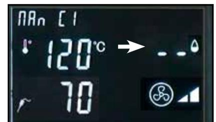
**HINWEIS** - Für die Modelle RRO/RRT ist die Funktion "Climachef" eine Option. Wenn diese Option nicht inbegriffen ist, wird die Maschine automatisch nur die Einspritzung von Feuchtigkeitswasser je nach der Prozentsatz einstellen, dagegen wird das Entlüftungsventil manuell geöffnet/geschlossen. Deswegen können das automatische Ventil, das Schliessen des selben Ventils (---) und die Funktion "Flash Dry" nicht benutzt werden.
