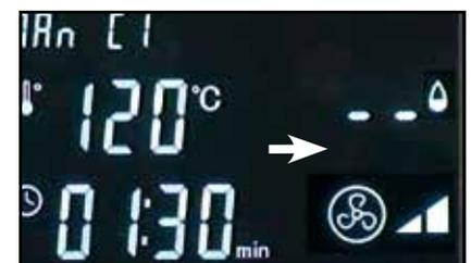
**HINWEIS** - Für die Modelle RRO/RRT ist die Funktion "Climachef" eine Option. Wenn diese Option nicht inbegriffen ist, wird die Maschine automatisch nur die Einspritzung von Feuchtigkeitswasser je nach der Prozentsatz einstellen, dagegen wird das Entlüftungsventil manuell geöffnet/geschlossen. Deswegen können das automatische Ventil, das Schliessen des selben Ventils (---) und die Funktion "Flash Dry" nicht benutzt werden.
